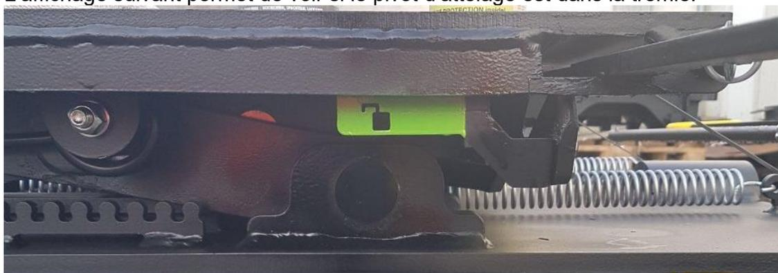
Selon la durée pendant laquelle l'affichage est visible (rouge ou vert > dépend du client), alors le pivot d'attelage n'est pas dans la trémie. Le pivot d'attelage se trouve dans la trémie uniquement quand l'affichage n'est plus visible.
